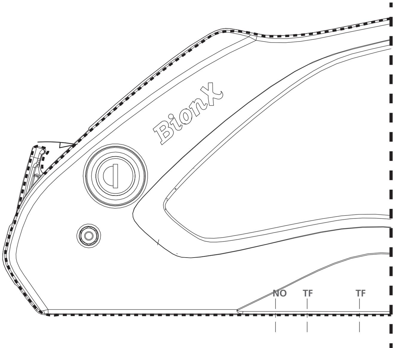
Découper le gabarit de la batterie et utiliser les indications sur les trous servant à installer le porte-gourde sur le cadre. Les trous pour vis à tête plate doivent être utilisés ensemble, les trous pour vis à tête fraisée avec les trous correspondants. Toujours tenter d'utiliser les trous pour vis à tête plate en premier. Laisser 2,54 cm (1 pouce) de dégagement afin de retirer plus facilement la batterie et station d'accueil.
